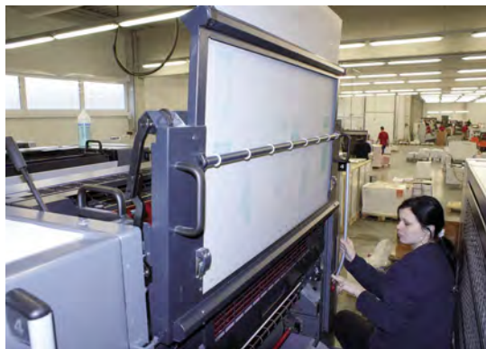
Výměna tiskové desky
