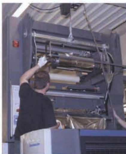
Umistování odvíjecí segmentové hřídel s rolí metalické fólie do modulu FoilStar
