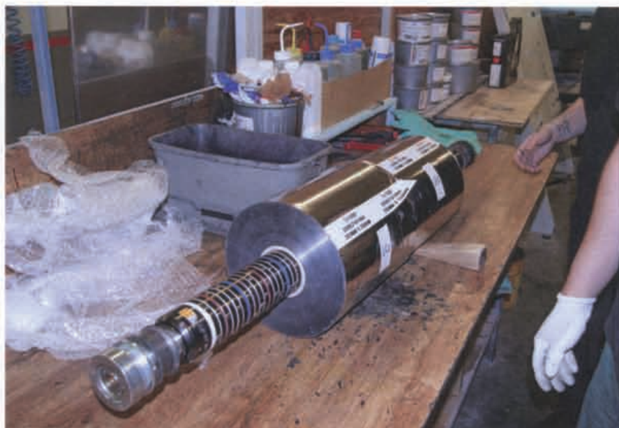
Segmentová hřídel umožňuje upnutí až šesti rolí metalické fólie s maximální šířkou 80 mm
