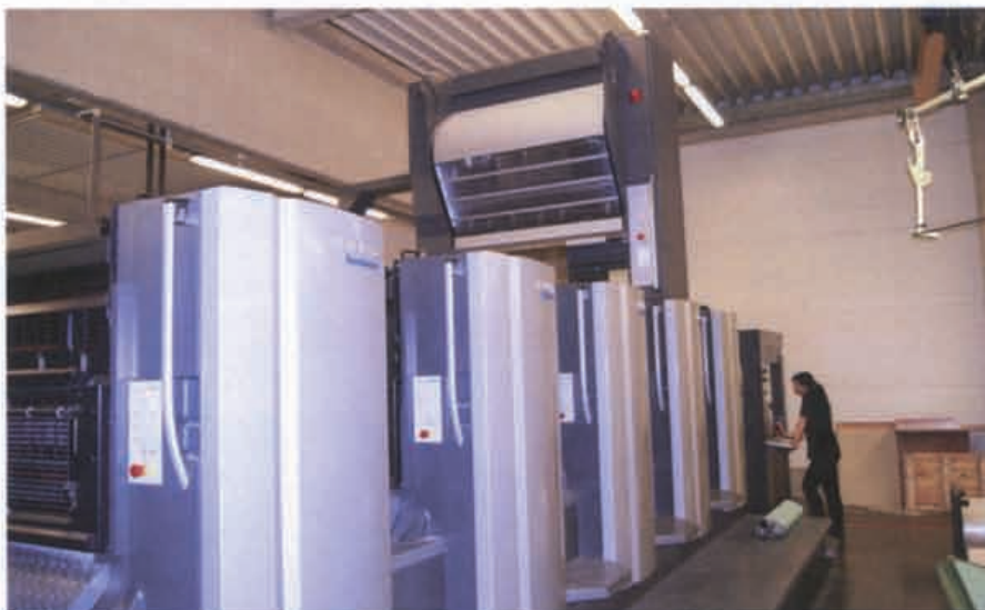
Modul FoilStar na aplikaci metalické fólie pomocí studené ražby umístěný na archovém ofsetovém stroji Speedmaster CX 102-6+LX2
